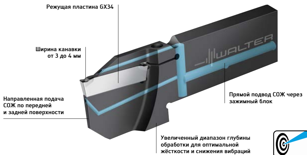
Державки с направленной подачей СОЖ — режущие пластины GX34
